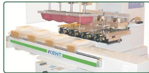
高速、精确伺服马达推送器：高达1,200 毫米/秒
